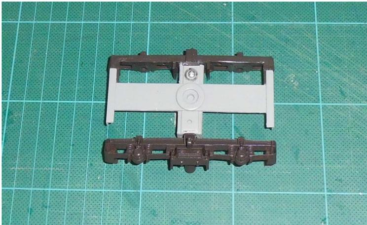
Die Drehgestelle werden mit Metall Radsätze bestückt, (statt mit Kunststoff Räder) und in die Gleitlager montiert.
