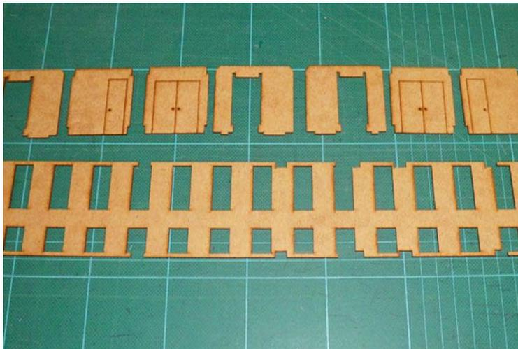
Die Abteilwände und die Bodenplatte werden mit Spritzspachtel besprüht und weiter grundiert..
